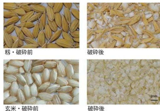
図 2 破碎処理前後の粃および玄米の外観
