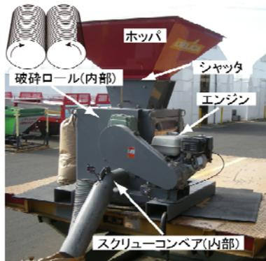
図 1 飼料用米破碎機の外観
