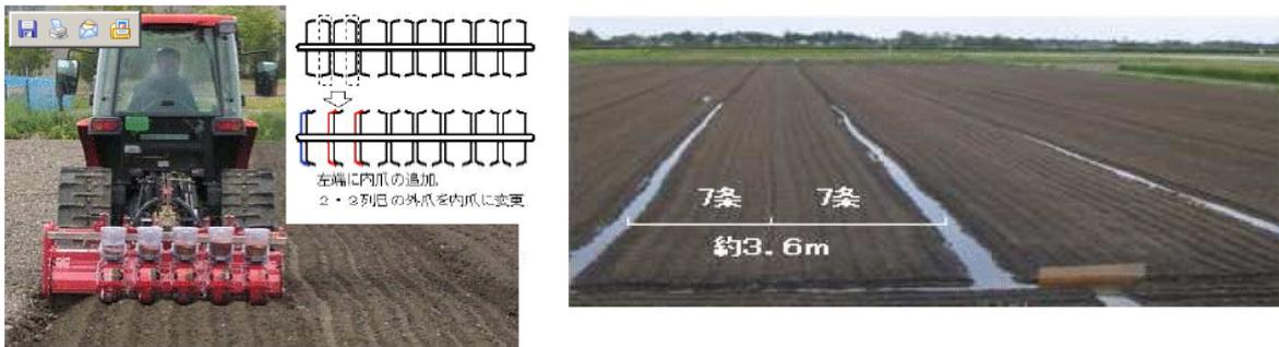
図1. 広畝同時播種作業と通水時の様子
