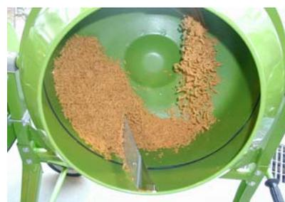
写真 ミキサーによる造粒
