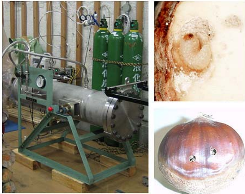
図 高圧炭酸ガス装置(左、外径40cm・長さ155cm)とクリシギゾウムシ幼虫(右上)によるクリ果実被害(右下)
