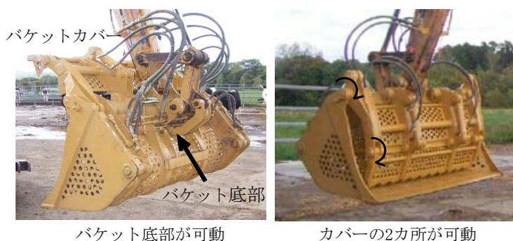
図1 開発機の外観（左：カバー開、右：カバー閉）
