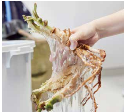
水に原料とトロロアオイの根から採れる粘液を 加えて攪拌します。
