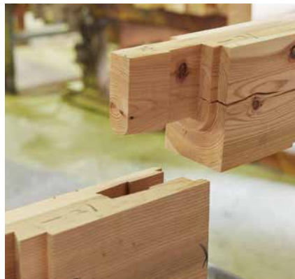
日本の建築ではプレカット材を使った施工が 大部分を占めています。
