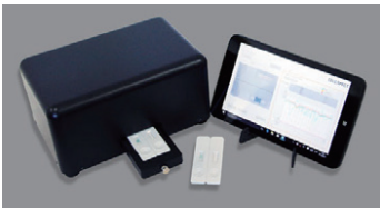
QBS™(Quick Blood Separator)及びPOCTアナライザー 遠心分離を必要とせず、血漿を分離し迅速な測定を可能とする。
