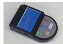
H社の血中濁度測定器。これにより注射針で採血することなく、血液情報が得られる。
