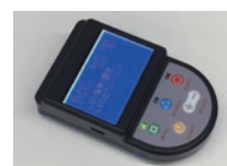
H社の血中濁度測定器。 これにより注射針で採血することなく、血液情報が得られる。
