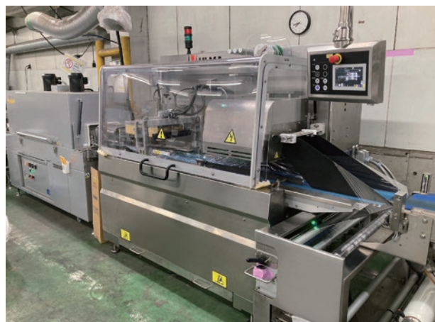
プロセスセンター内に設置した青果シュリンク包装機
