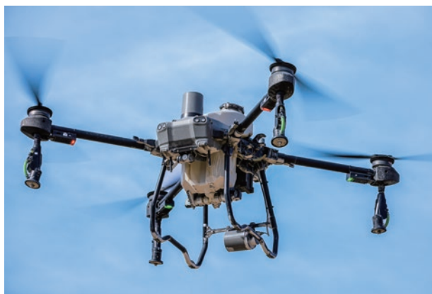
高圧噴射システムを搭載したドローン
