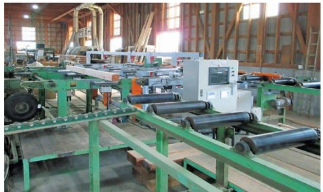
木材の強度を測定する装置を導入した木材工場
