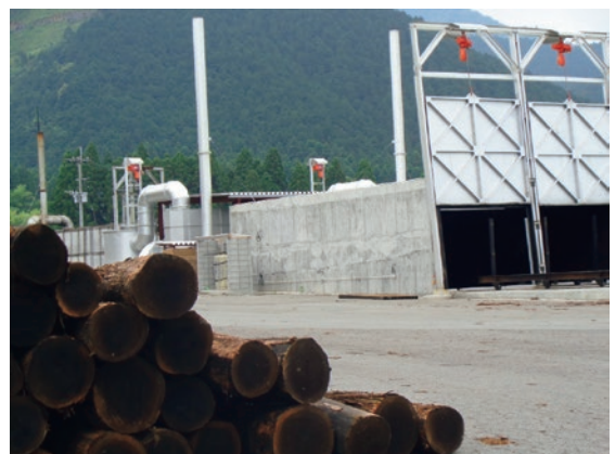
熱処理された原木と熱処理施設
