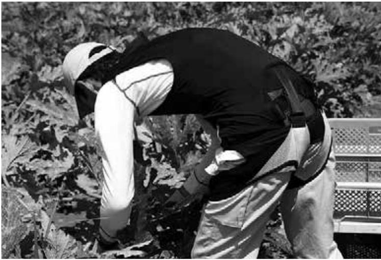
北海道札幌市の(株)スマートサポートが開発した「スマートスーツ」を着用すると、農作業などで前かがみの姿勢になったときに、腰への負担を和らげることができます。可能にしているのは、肩口から背中を通ってお尻までつながっているゴム製のバンドと、この弾性を調節するセンサーで制御されたモーターです。腰を曲げると、その角度や加速度をセンサーが感知。腰回りの筋肉や関節への負荷が最も軽くなるように、バンドの長さをモーターで調節します。
