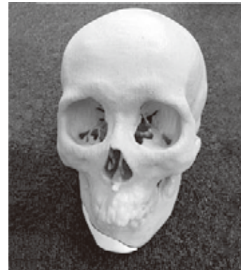
図-7 3Dプリンター（インクジェット方式）で製作した人工骨
