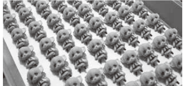
図-9 3Dプリンター(インクジェット方式)で造形した多色フィギュア
