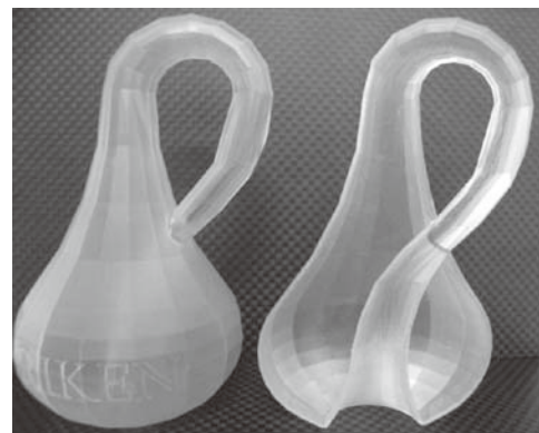
図-4 3Dプリンターにしか造形できない形状（クラインの壺：光造形法による）
