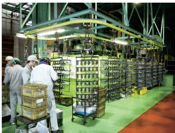
亜鉛めっき作業の様子 (出所) NKSJ リスクマネジメント社 撮影
