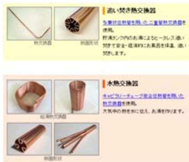
図表 3-11 多葉状伝熱管を用いた二重管式熱交換器(上)及びキャピラリーチューブ抱合伝熱管(下)
