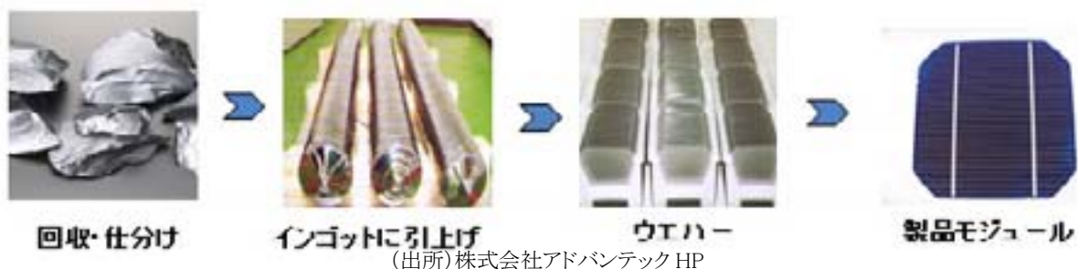
図表 3-5 太陽電池へのシリコンリサイクル
