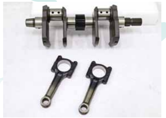
オートバイエンジンの試作品(クランクシャフト・コンロッド等)
