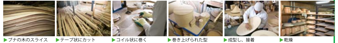
▶ブナの木のスライス ▶トレー状にカット ▶コイル状に巻く ▶巻き上げられた型 ▶成型し、接着 ▶乾燥
