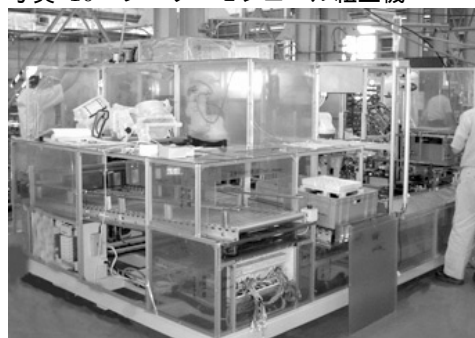
写真10 ブロワーモジュール組立機
